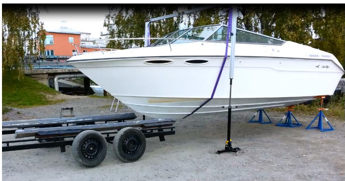
Stöttor placerade tätt under aktern varefter fören lyfts upp. Trailern kan sedan rullas bort och fören sänkas ned tex på en bock
